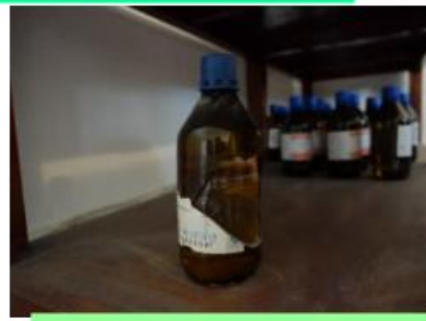
一瓶高分子单体存放中发生自聚合，瓶子被炸破
